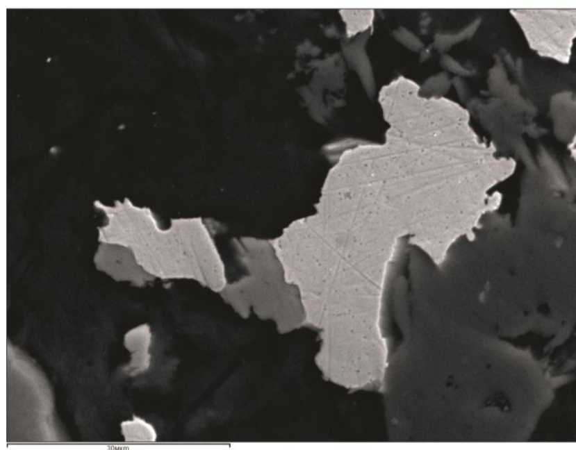
Рисунок 10. Пластинчатые включения золото в лимоните в сростании с редкими землями (фосфат лантан-церновой группы), увеличенный фрагмент, зонд, ув. 3000, аншлиф Г-374
