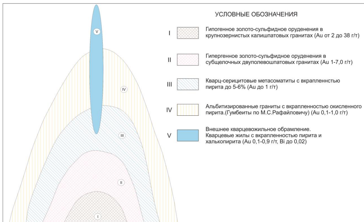
Рисунок 5 Вертикальная геолого-метасоматическая зональность месторождения Кыргау
